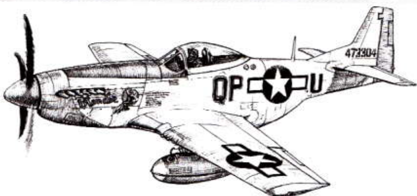
●水滴形キャノピーの採用により後方視界が改善し、武装も強化されたP-51D。
